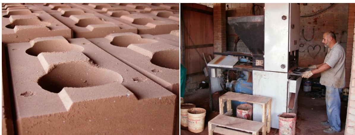
Figura 11. Tijolo produzido pela prensa hidráulica, com foco no detalhe do encaixe entre tijolos.
