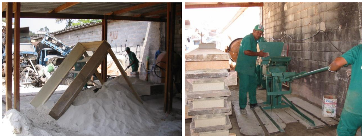
Figura 3. Peneiramento do solo com o uso de peneiras tipo ciranda, sobre as quais o solo é lançado com pás.
